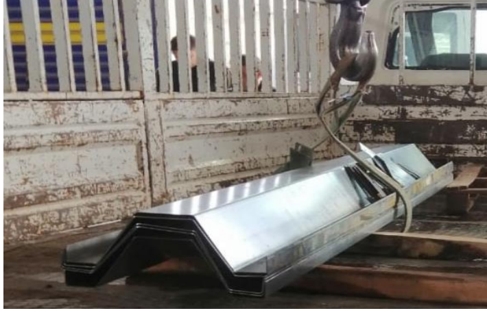
Şekil 59. İkinci reflektörün üretiminin son hali
